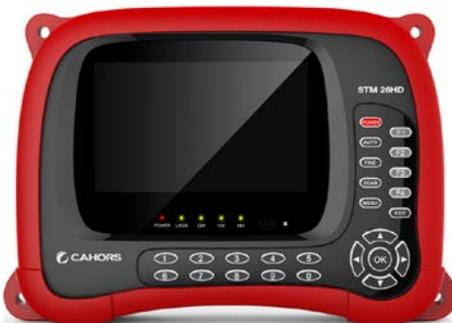
**Touche de marche/arrêt (POWER)** : permet de mettre le produit sous/hors tension.
